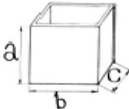
A=600мм., B=1000мм., C=1000мм., толщина свариваемого металла 5 мм., материал сталь 30.
