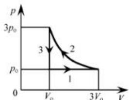
На  $pT$ -диаграмме отображена последовательность трёх процессов ( $1 \rightarrow 2 \rightarrow 3$ ) изменения состояния 2 моль идеального газа. Какова эта последовательность процессов в газе?
